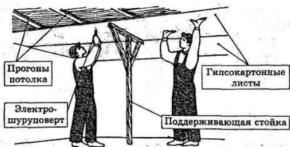
Рис. 9. Облицовка потолка ГКЛ
